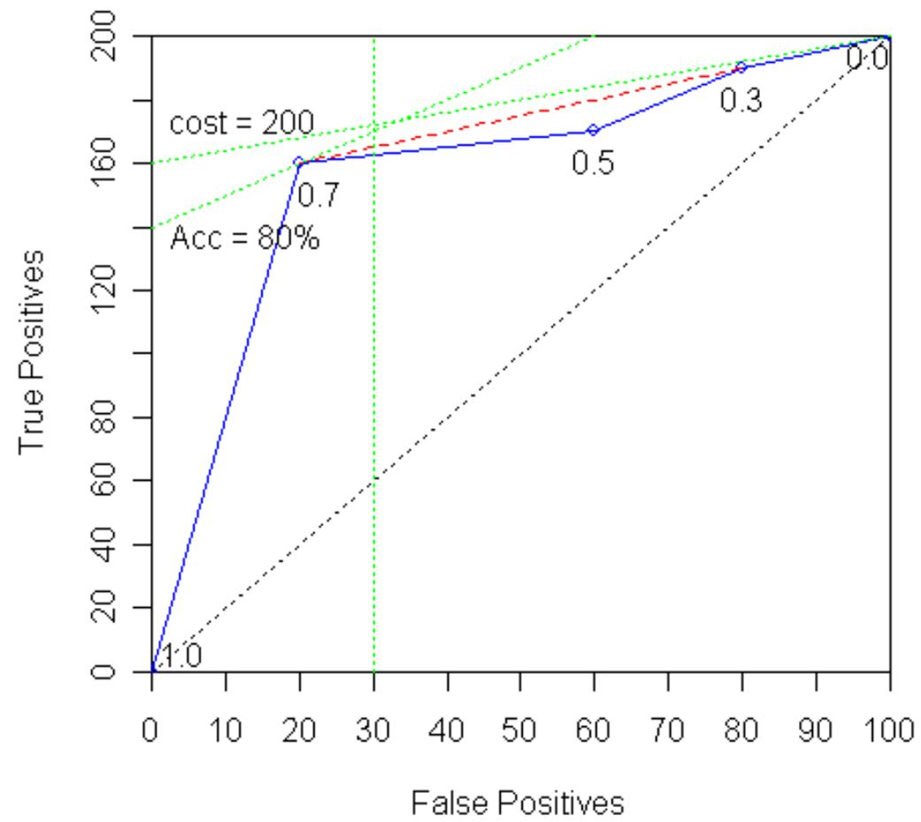
Die Länge der  $x$  und  $y$ -Achse ist gleich, wobei auf der  $y$ -Achse jeder Achsenabschnitt 20 tp's und auf der  $x$ -Achse 10 fp's entspricht. Um auf die jeweiligen "Rates" zu kommen dividiert man die Werte der  $x$ -Achse durch 100 und die der  $y$ -Achse durch 200. Um aber besser einzeichnen zu können, sind die Achsen wie in der Grafik gezeichnet.
